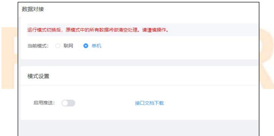
联网模式分为 MLink 协议和 MQTT 协议，其中默认为 MLink 协议。Mlink 协议默认服务器地址为 `mlink.miniclouds.cn`，默认端口为 21883；MQTT 协议默认服务器地址为空，端口显示为 1883。
