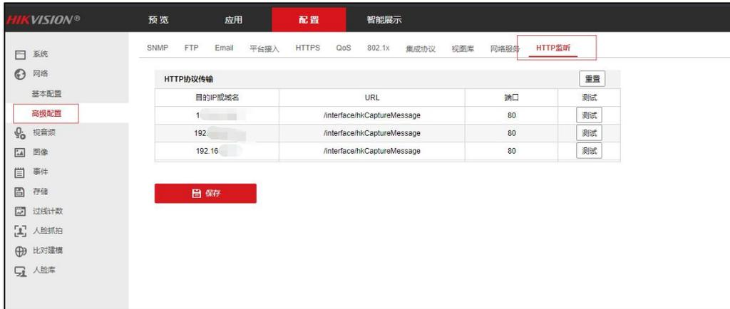
设置目的 IP，IP 为盒子的 IP 地址，URL 填写为 /interface/hkCaptureMessage，端口为默认 80，设置完成，点击测试，若是显示服务可用，则配置成功，页面显示如下：
