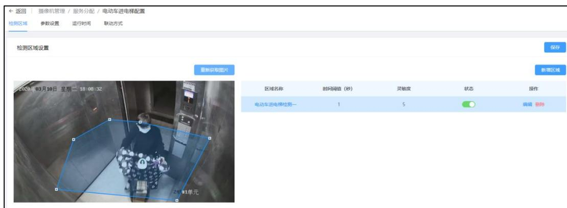
**注意：**批量应用按钮：点击批量应用按钮，可以将检测区域的区域名称、时间阈值、灵敏度、状态批量应用到所选的通道，列表展示的通道不含自身，如无则通道区域展示为空选择单个或多个通道后点击确定，根据同步结果，toast 提示“参数同步成功”。
